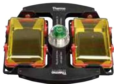
M-20 水平转头<sup>1</sup>, 90°, R<sub>max</sub> 127 mm
