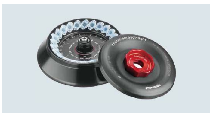
FA-45-24-11-Special，气密性固定角转，容量 24 × 1.5 / 2.0 mL，独有 PTFE 涂层，可进行苯酚、氯仿等强腐蚀性样品的离心，最大相对离心力高达 21,130 × g / 15,000 rpm。货号：5424 700.004
