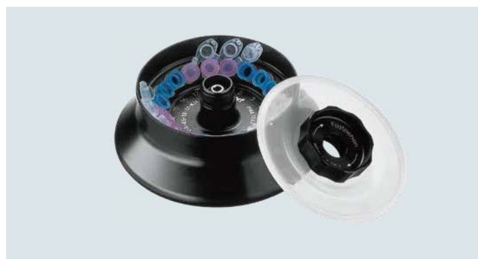
F-45-18-11-kit, Eppendorf Kit rotor 固定角转，最大相对离心力为 18,111 × g / 15,000 rpm，适用于 18 × spin columns 管或 18 × 1.5/2.0 mL 离心管。独有加宽的边缘，防止开盖离心时，意外打掉管盖。货号：5424 706.002
