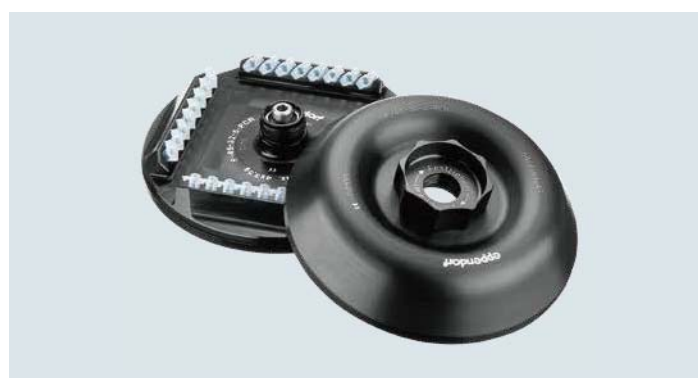
F-45-32-5-PCR，PCR 排管固定角转，最大相对离心力为 18,615 × g / 15,000 rpm，适用于 4 × PCR 8 排管或 32 × 0.2 mL PCR 单管。货号：5424 704.000
